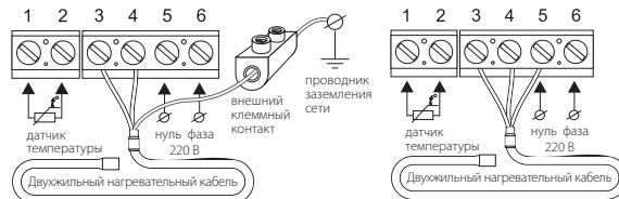
Схема подключения к 3-х проводной электрической сети
